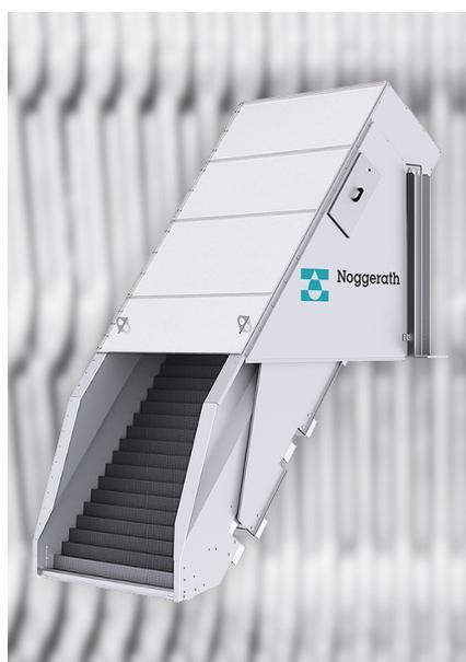
El tamiz de escalera Noggerath® PSS-R de Aqseptence Group se utiliza principalmente en la primera etapa de la limpieza mecánica. Se instala directamente en el fondo de un canal o en tanque superficial.
